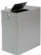
Расширительный бак **емкостью 40 литров** предназначен для установки и использования в открытой системе отопления. Изготовлен из стали марки Ст.3СП5, **толщиной 3 мм** с использованием полимерного окрашивания. Имеет аналогичный котлам серии "Сибирь КВО" цвет. Бак имеет 2 крепления для установки на стену.
