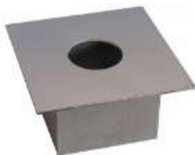
**Потолочный проходной узел** представляет собой специализированный монтажный элемент дымоходной системы, используемый для прокладки дымохода через потолочное перекрытие или стену. Он обеспечивает пожарную безопасность отделяя теплонагруженные элементы дымохода от горючих конструкций здания. Данный узел изготовлен из негорючих материалов, а именно его короб выполнен из фиброцементной плиты, а внешние элементы из нержавеющей стали.
