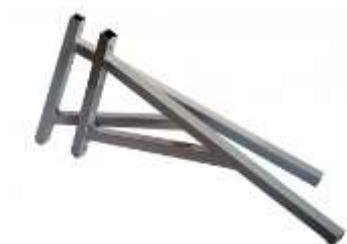
**Крепление стеновое** предназначено для установки в комплексе с дымоходной системой и располагается снаружи здания. Оно выполняет опорную функцию и удерживает дымоход на необходимом для монтажа расстоянии. Его установка позволяет неподвижно зафиксировать монтажную площадку, относительно вертикальной поверхности, исключает горизонтальное смещение дымохода и переносит вес выше расположенной конструкции на стену здания.
