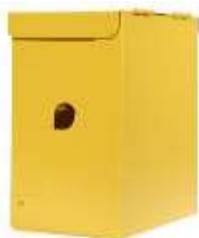
Металлический шкаф для газового оборудования выполнен из стали марки Ст.3 СП5 толщиной 1мм. На шкаф нанесена полимерная краска желтого цвета, которая придает изделию привлекательный внешний вид. Он также оснащен специальными отверстиями для входной газовой магистрали. Наличие шарниров в верхней части позволяет удобно открывать данный шкаф для проведения ревизии и других технических процедур. Данный шкаф может быть
