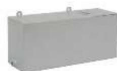
Расширительный бак емкостью **20 литров** предназначен для установки и использования в открытой системе отопления. Изготовлен из стали марки Ст.3СП5, толщиной 3 мм с использованием полимерного окрашивания. Имеет аналогичный котлам серии "Сибирь КВО" цвет. Бак имеет 2 крепления для установки на стену.
