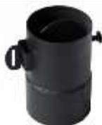
**Переходник с шибером горизонтальный Ø150 мм (круглый/круглый)** предназначен для установки на котлы серии: **КВО «СИБИРЬ» 10-15-20, «Гефест», «Магнум»**. Его диаметр составляет 150 мм. Шиберная заслонка может принимать в переходнике 4 положения, регулируя тягу. Круглый переходник служит для:
