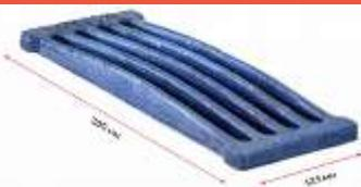
Колосник выполнен из **литого чугуна марки СЧ-10** и предназначен для установки на **котлы серии "Сибирь-КВО"** мощностью 10/12/15/20 кВт соответственно.
