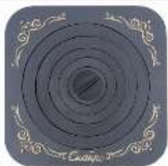
**Плита чугунная под казан "Сибирь" с конфорками** предназначена для установки в металлических или кирпичных печах. Габаритные размеры плиты 520 x 520 мм, **толщина 12 мм**, масса 22,5 кг. Плита под казан "Сибирь" изготовлена из чугуна специального состава
