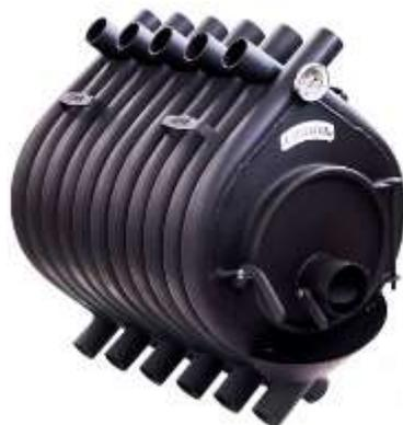
Воздухогрейная печь "Сибирь БВ" - 180 - это инновационная запатентованная модель завода "НМК". Печь представляет собой цельнометаллическую конструкцию, состоящую из **11-ти соединенных между собой металлических труб круглого сечения**, обеспечивающую естественную конвекцию. Благодаря этому происходит быстрое нагревание воздуха и его плавное распределение по всему объему помещения.
