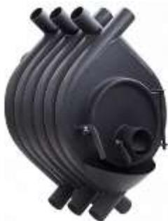
Воздухогрейная печь "Сибирь БВ" - 100 является наименьшей по мощности отопительной печью в линейке "Сибирь БВ". Ее номинальная мощность составляет 4 кВт. Данная печь рассчитана на обогрев небольших гаражей, теплиц, цехов и дачных домиков объемом от 30 до 100 м³. Модель печи "Сибирь БВ" представляет собой бюджетный вариант серии воздухогрейных печей "БВ", а именно, в ней отсутствует термометр, резиновый уплотнитель на дверной ручке, двойная стенка топочной камеры.
